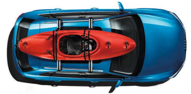
Крепление для байдарки Для одиночной байдарки массой до 45 кг. С регулируемым углом наклона. Крепление для байдарки и стяжные ремни имеют отдельные замки. Используется только в сочетании с поперечными рейлингами.
